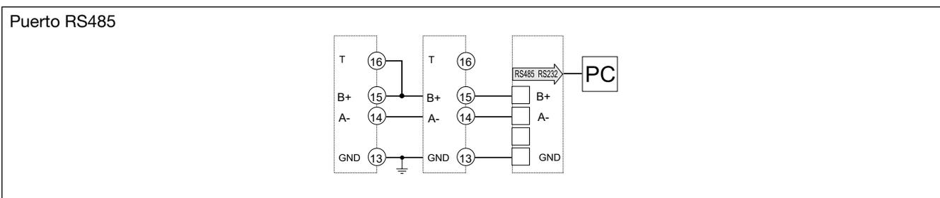
**NOTA:** Los dispositivos adicionales suministrados con el RS485 se conectan como se muestra arriba. La terminación de la salida en serie solo debe de ser conectada al último instrumento de la red, mediante un puente entre (B+) y (T).
